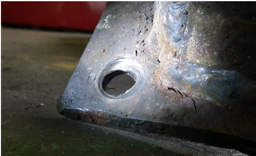
8. ábra: a lemez sarka a megkopott csavarfurattal
