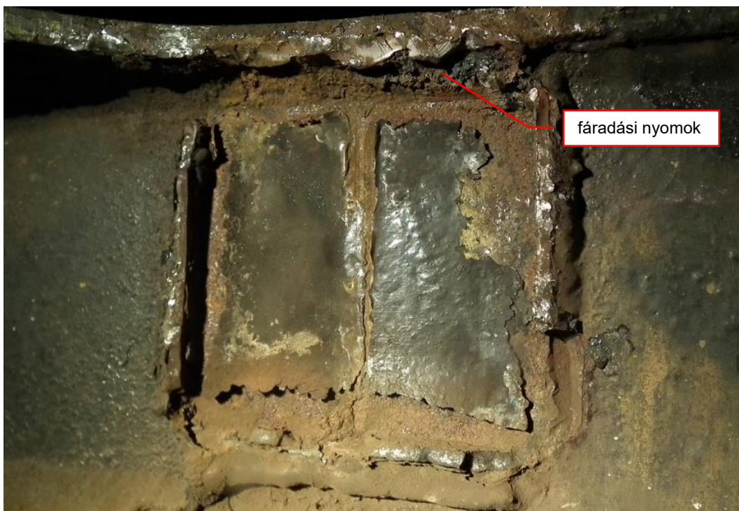
6. ábra: a bal konzol eltört hegesztése
