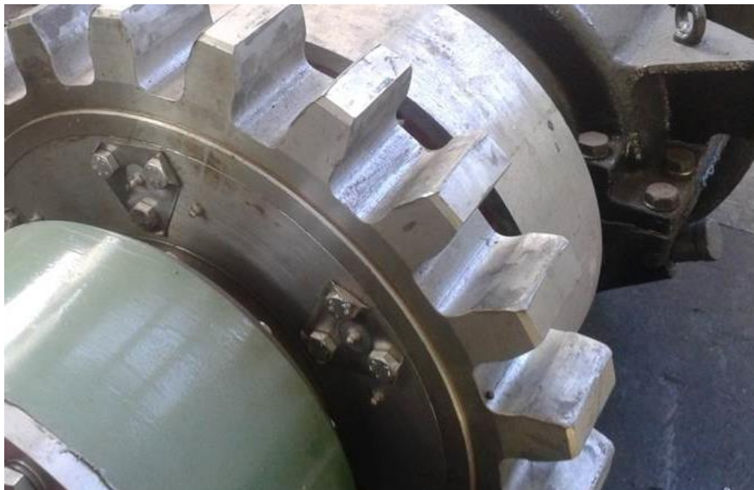
24. ábra: új fogaskerék egy menet után, jól láthatóan kopott és kimángorlódott fogakkal (fotó: BKV Zrt.)
