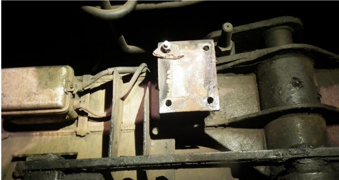
7. ábra: a pályakotró jobb konzolja, törött lemezzel
