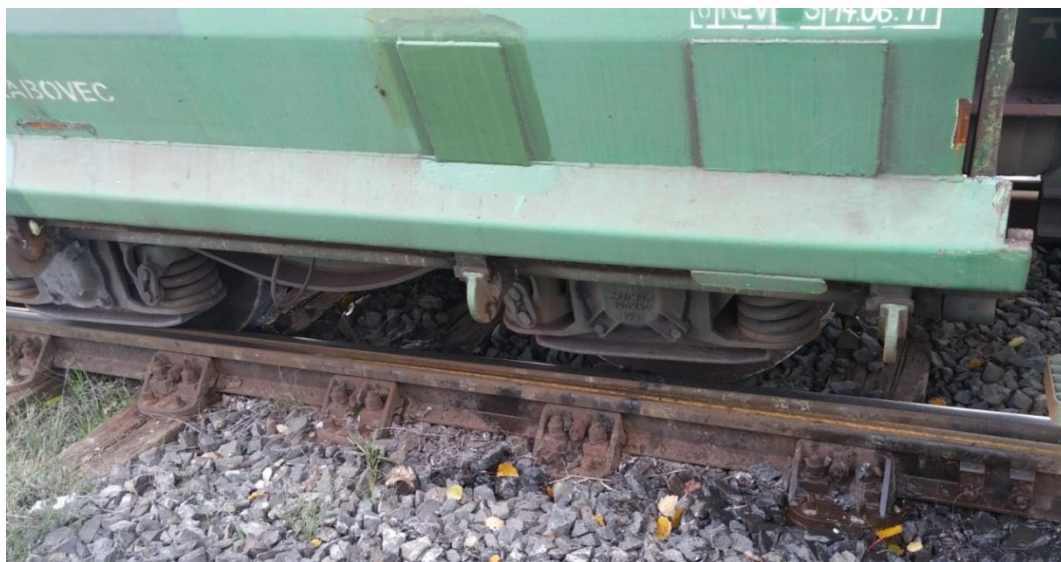
4. ábra: A kisiklott kocsi kerekei az 5. sz. váltó csúcscsínjei között
