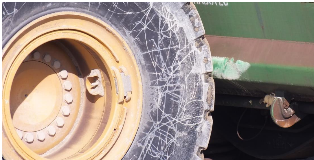
9. ábra: Keréknyomok a vasúti kocsi oldalán
