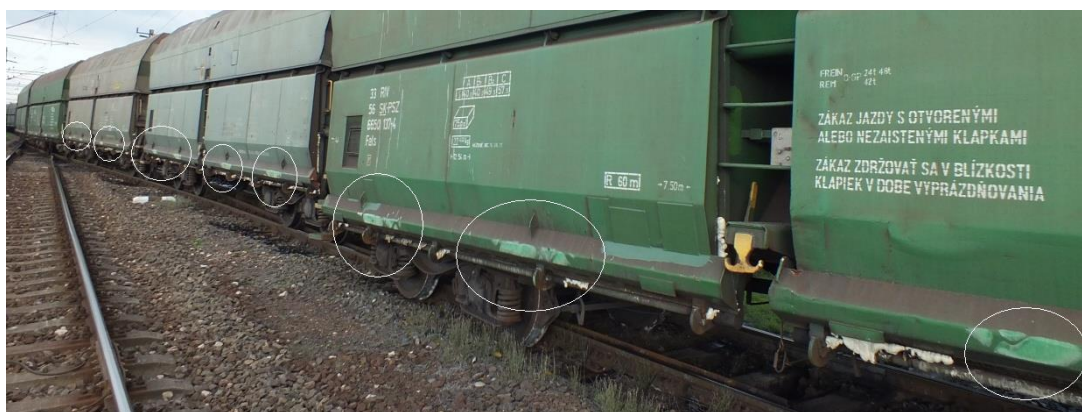
10. ábra: A rakodógép kerekeinek nyomai a szerelvényen
