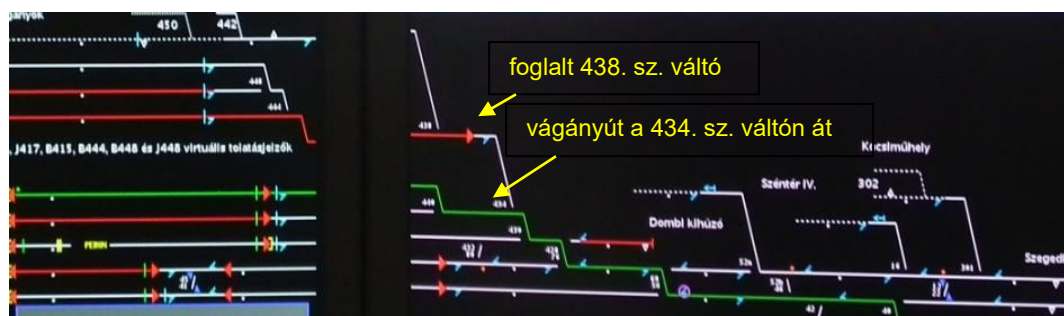
29. ábra: a torzított helyszínrajzon nem látható, hogy a 438-as váltó foglaltsága veszélyes a XI. vágányra
