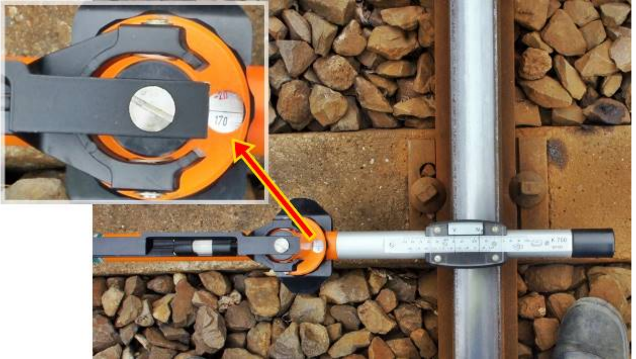
14. ábra: Túlemelés-érték a második siklás helyszínén (2015. július 27.)
