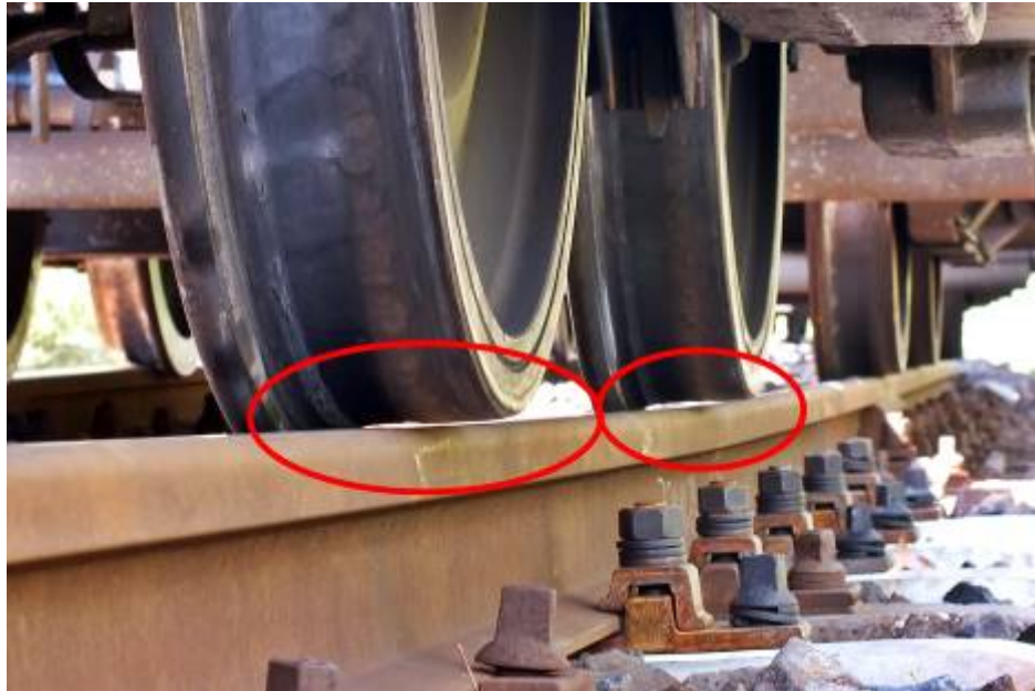
18. ábra: Sínkoronától elemelkedett futófelület (2015. szeptember 15.)
