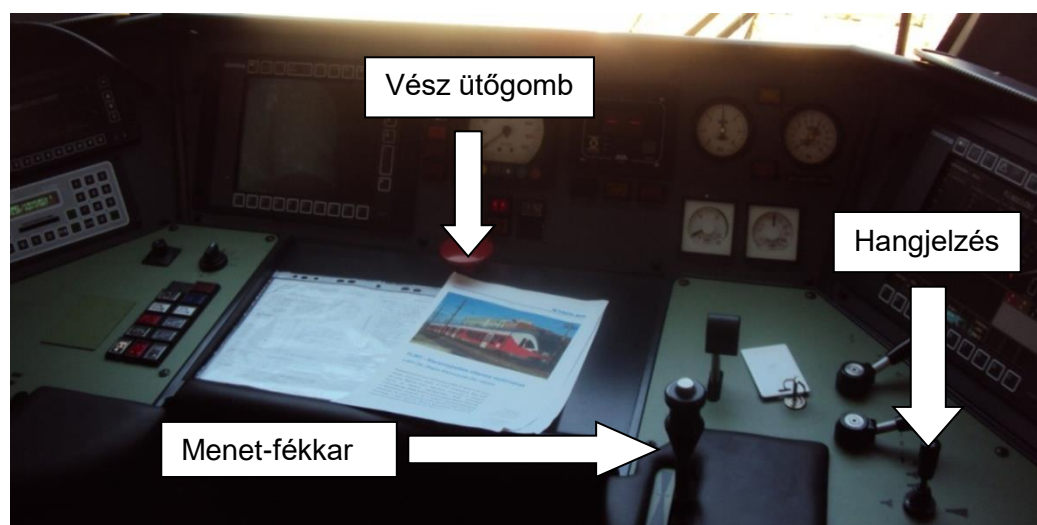
5. ábra: A motorvonat vezetőállása
