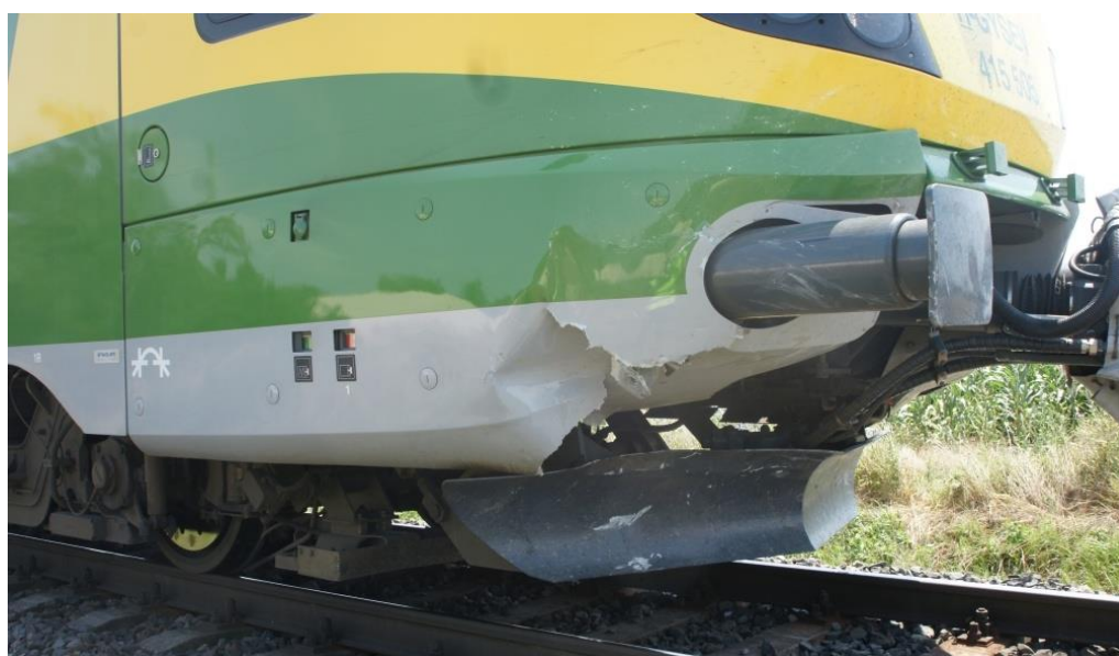
3. ábra: a motorvonat sérülései
