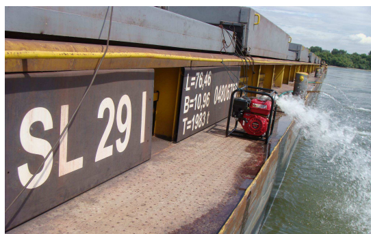
6. ábra: a lékesedett SL 29 I bárka szivattyúzása
