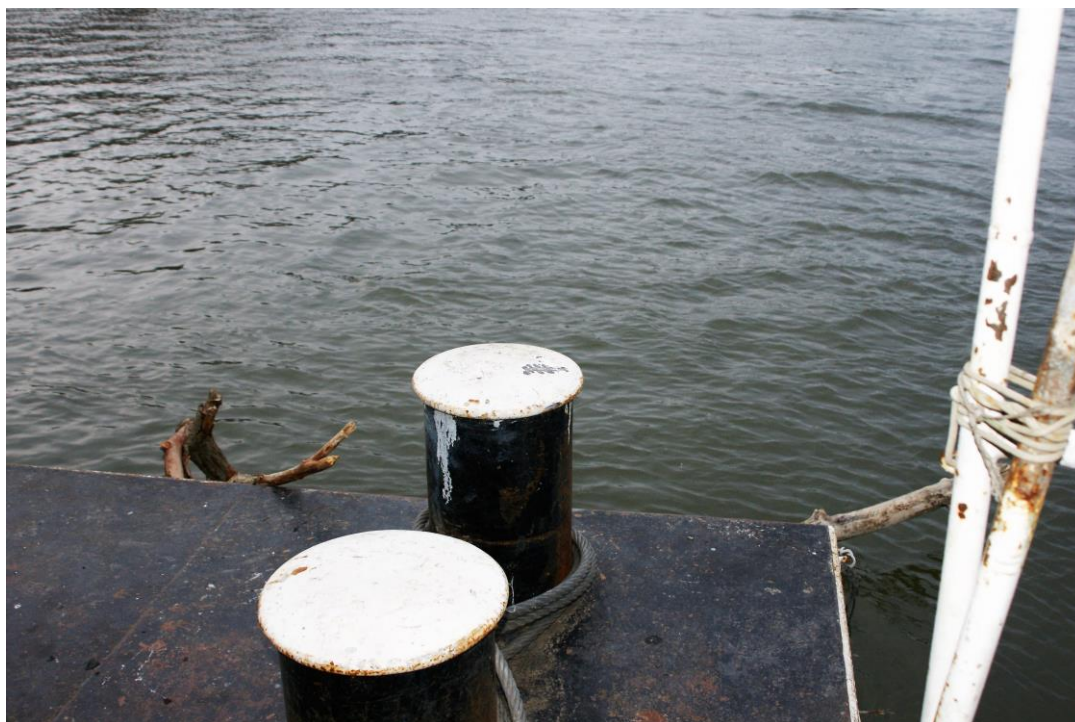
5. sz. kép: A festék-leverődés az úszómű első kikötőbakján
