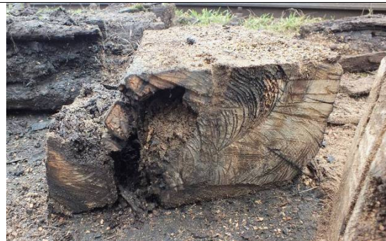
7. ábra: metszet a síncsavarok síkjában
