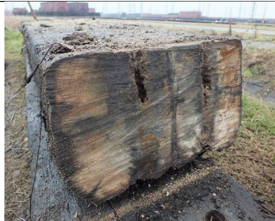
6. ábra: metszet a síncsavarok síkjában
