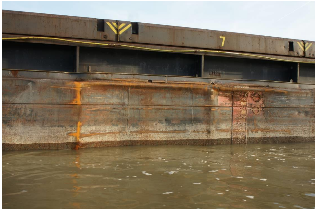
7. sz. ábra: A benyomódás a bárka oldalán
