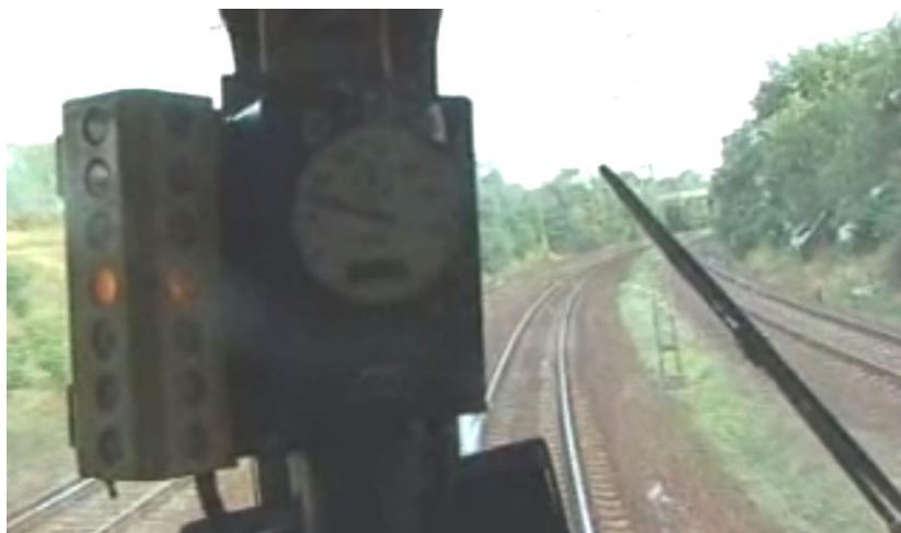
10. ábra: Sárga fény a vezetőállás jelzõn (a próba során készült felvétel)
