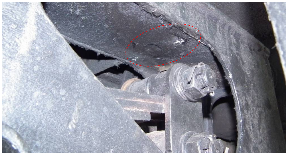
3. ábra: felütközési nyomok a forgóvázban
