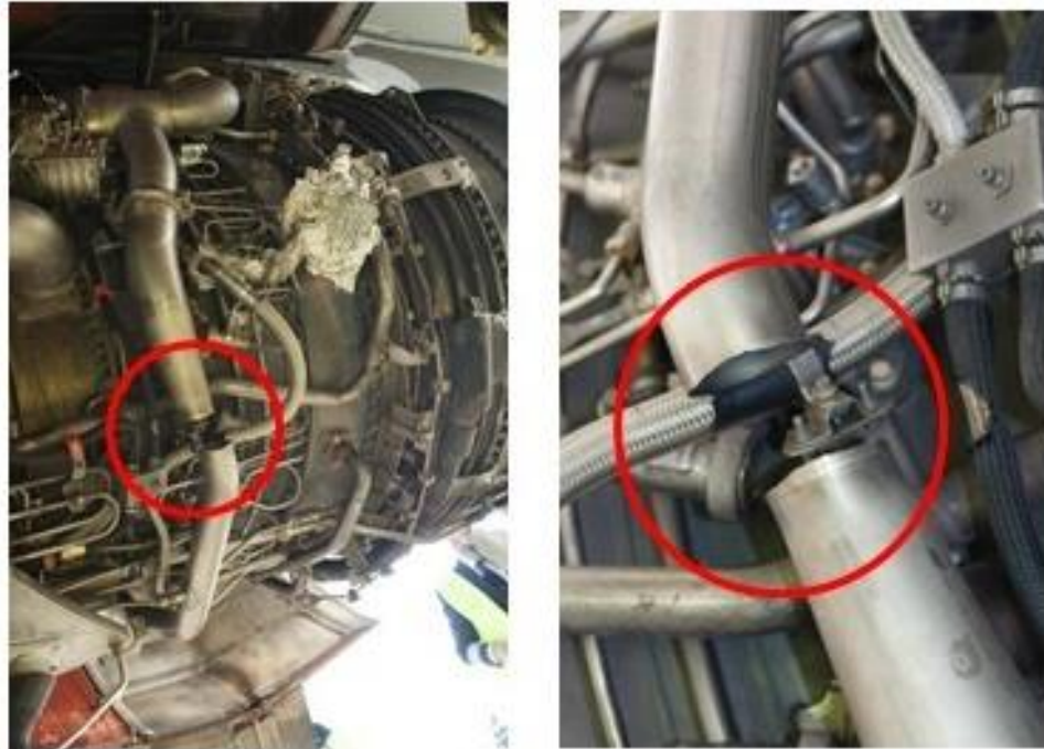
9. ábra A törött csővezeték a beépítés helyén
