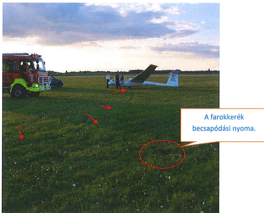
2. ábra A főfutón való néhány méteres csúszás nyomai a nyugalomba került repülőgéppel. (Fotó: PZ Nyíregyháza)
