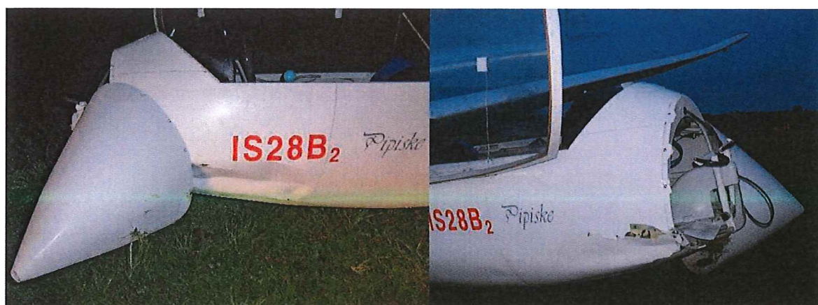
6. ábra A sérült repülőgép orr része a letört orrkúppal
