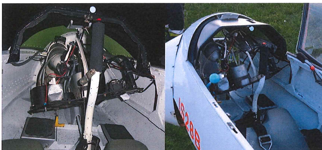
8. ábra A helyéről kibukott műszerfal
