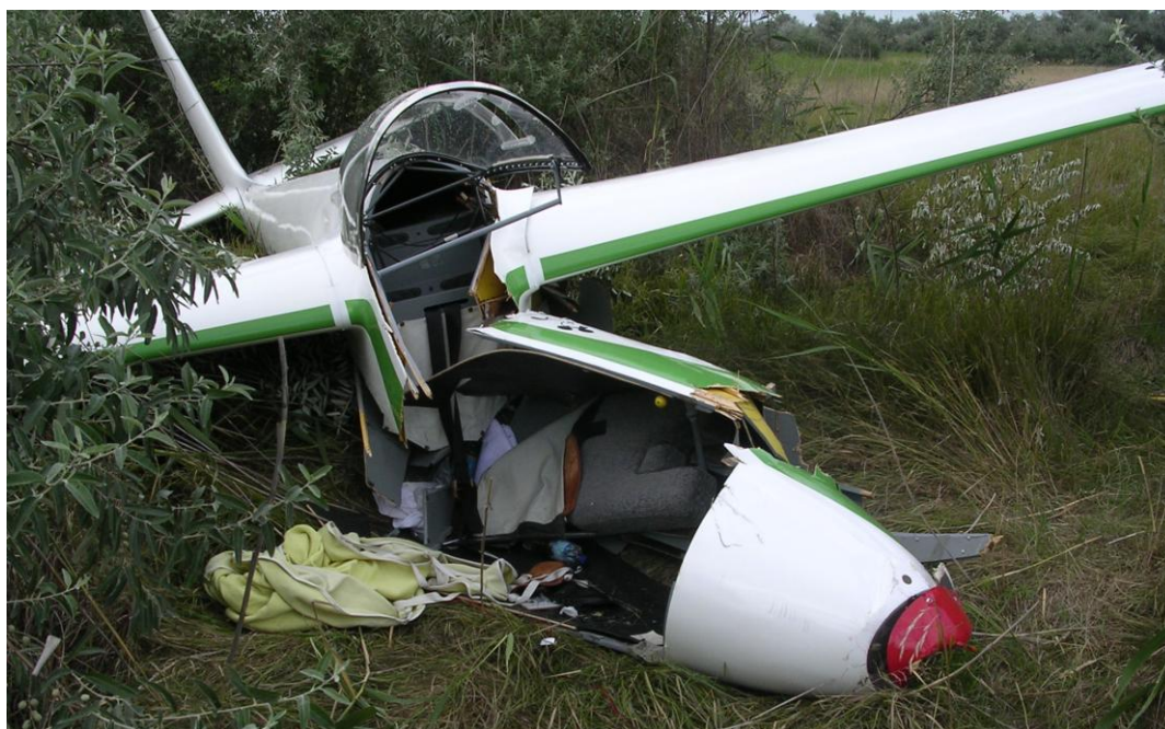
3. ábra: A repülőgép törzs első részének sérülése
