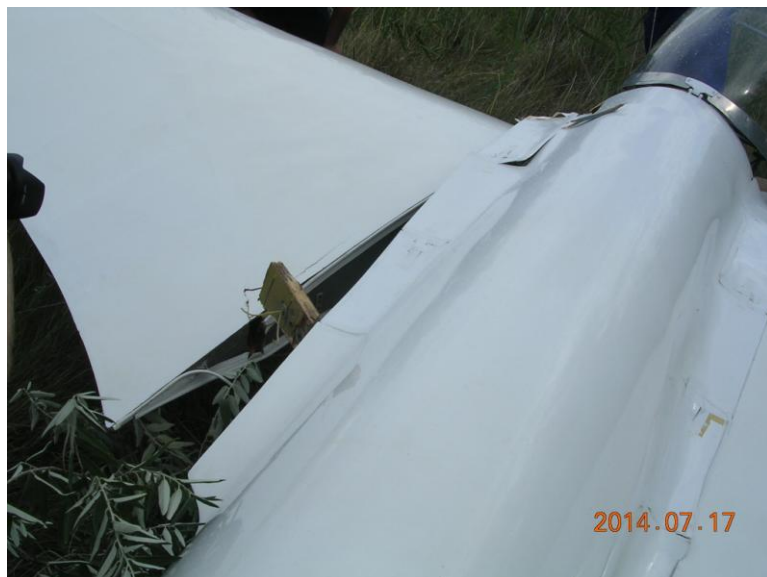
4. ábra: A repülőgép bal szárny-bekötésének sérülése
