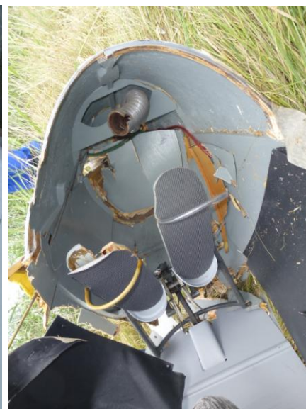
5. ábra: A repülőgép orr-rész sérülése
