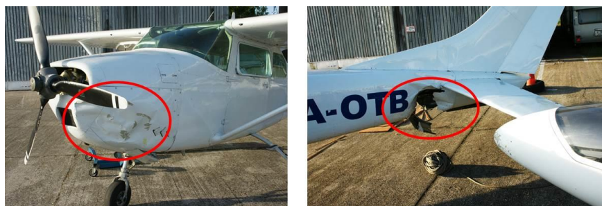
2. ábra: Cessna 182 típusú légijármű sérülései
