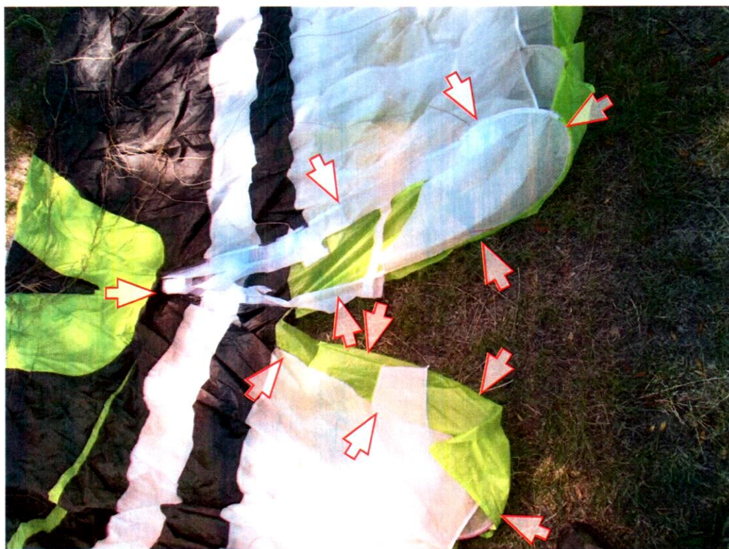
1. ábra A siklóernyő kupolájának szakadása.
