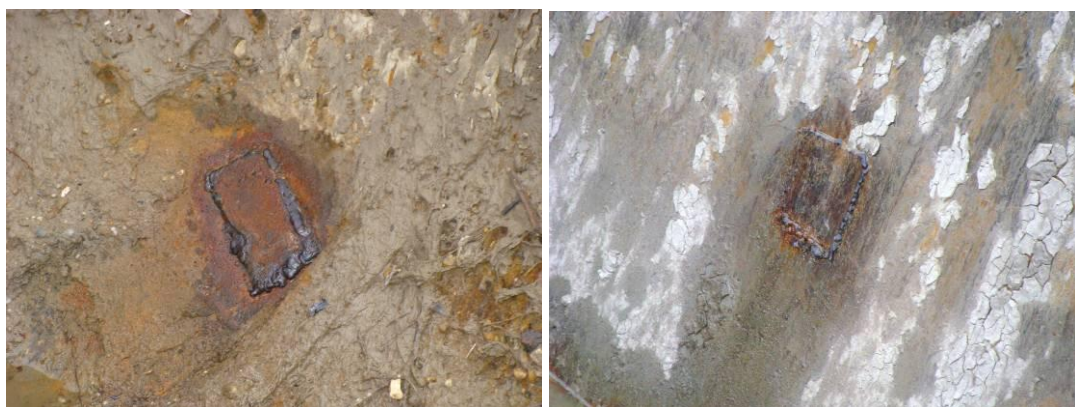
8. sz. ábra: A felhegesztett lemezek a raktér homloklemezén, illetve a jobb oldali oldalfalán
