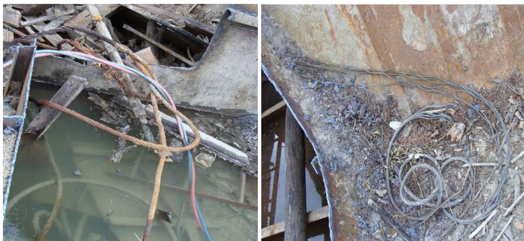
5. sz. ábra: A sérült, szakadt kikötőkötél
