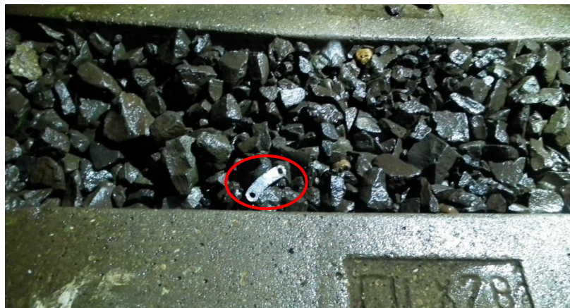
8. ábra A függeszték az úttájtáró után a vasúti pályán
