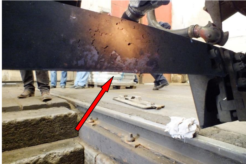
9. ábra Ütési nyom a pályakotrók összekötő gerendáján
