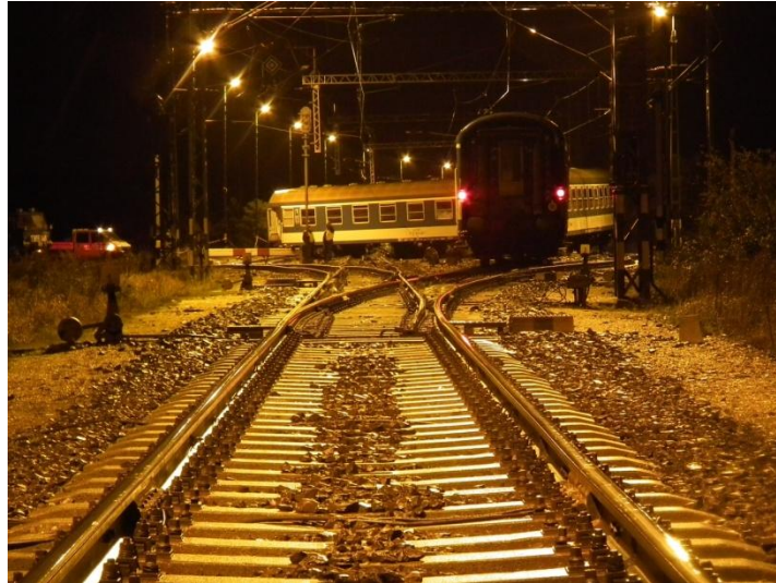
3. ábra A kisiklott járművek
