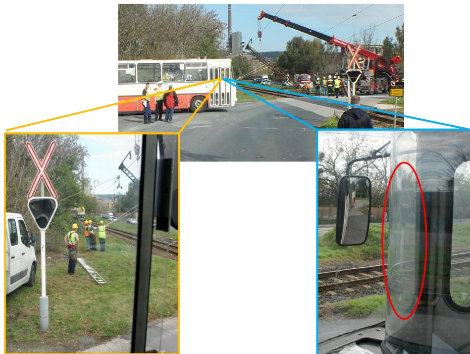
7. ábra Az átjáróhoz közeledő buszból a fénysorompó „f” és „d” árbocainak láthatósága (pirossal jelölve a „d” jelű árboc)
