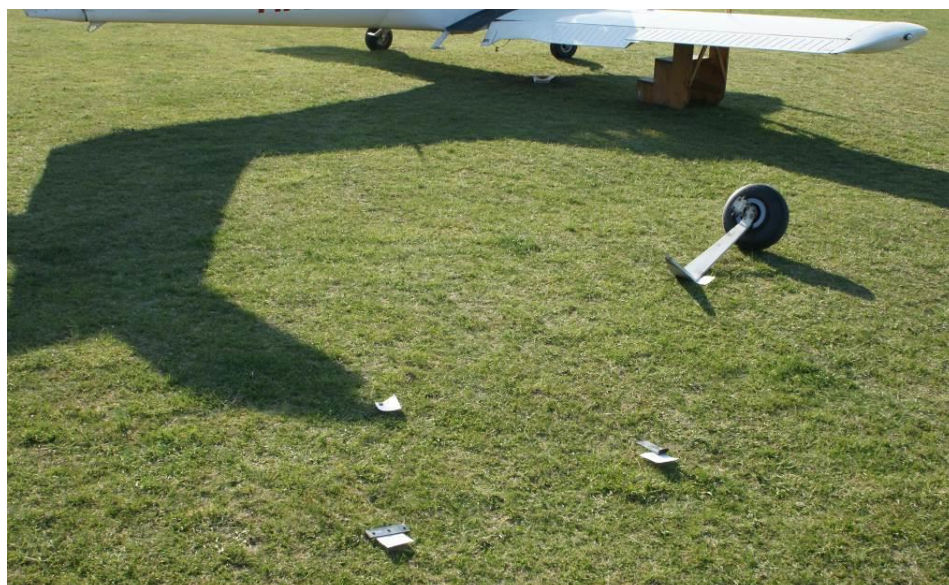
5. ábra: a repülőgépről levált alkatrészek elhelyezkedése az esetet követően
