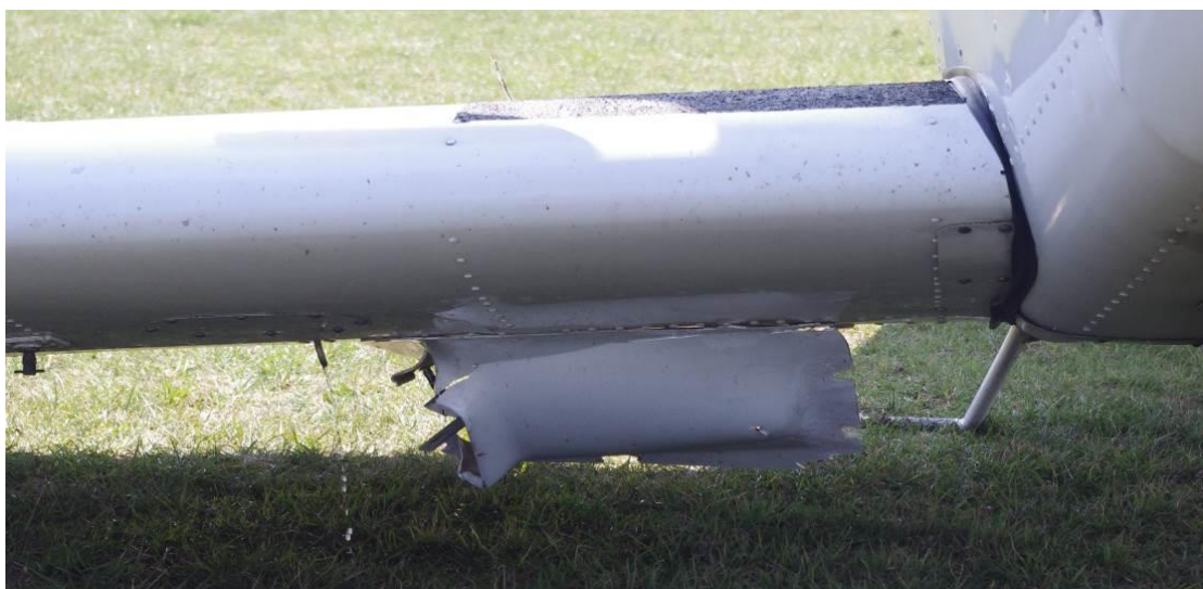
2. ábra: a jobb oldali szárny alsó részénél található benzintartály túlfolyócső
