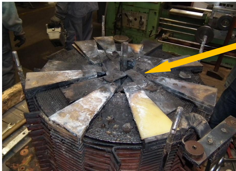
6. ábra: a tüzet okozó tekercselés
