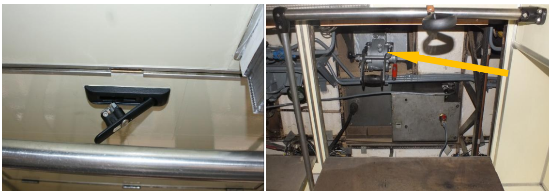
4. ábra: mennyezeti készülékszekrény ajtózár, földelőkapcsoló
