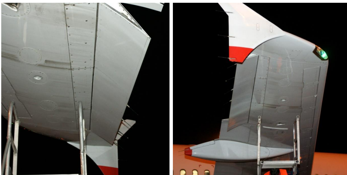
2. és 3.kép: a jobb oldali csűrő helyzete bekapcsolt hidraulika rendszerekkel a leszállást követően
