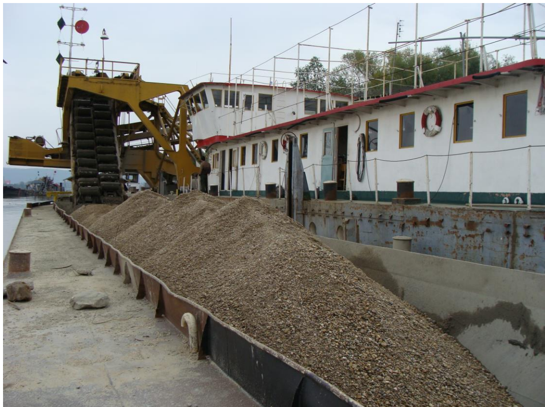
3. kép: A kotrólánc másik tagja, A PF 210 sz. úszómunkagép, amelyik a partra termeli a kotrési anyagot az uszályokból
