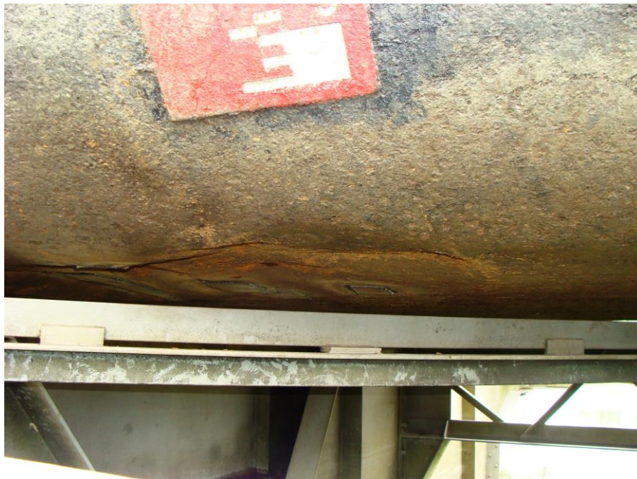
7. kép: Az uszály orr részén egy komolyabb benyomódás látható
