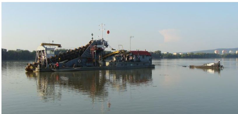
2. kép: A PF 120 sz. úszómunkagép (vedersoros kotró) mellett elsüllyedt PF 536 sz. uszály
