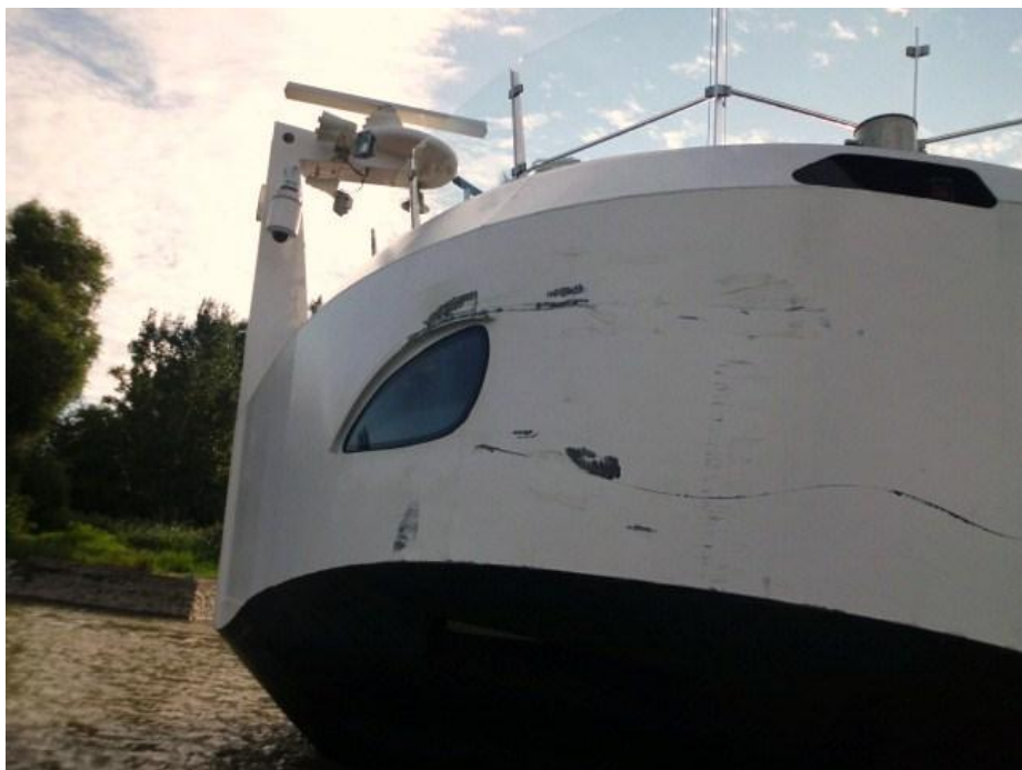
10. sz. kép: A Viking Rinda ms sérülése a hajó orr-részén
