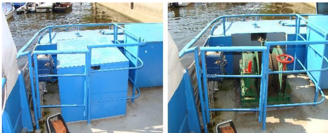
14. sz. kép: A korláttal és burkolattal elzárt, illetve leemelt burkolatú farhorgonycsőrő
