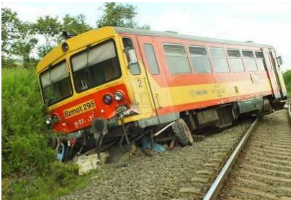
7. ábra A motorkocsi és a mezőgazdasági vontató pótkocsijának sérülése
