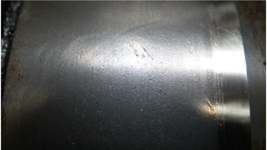
12. ábra: a sérülttel átellenes oldali csapágygyűrű felülete
