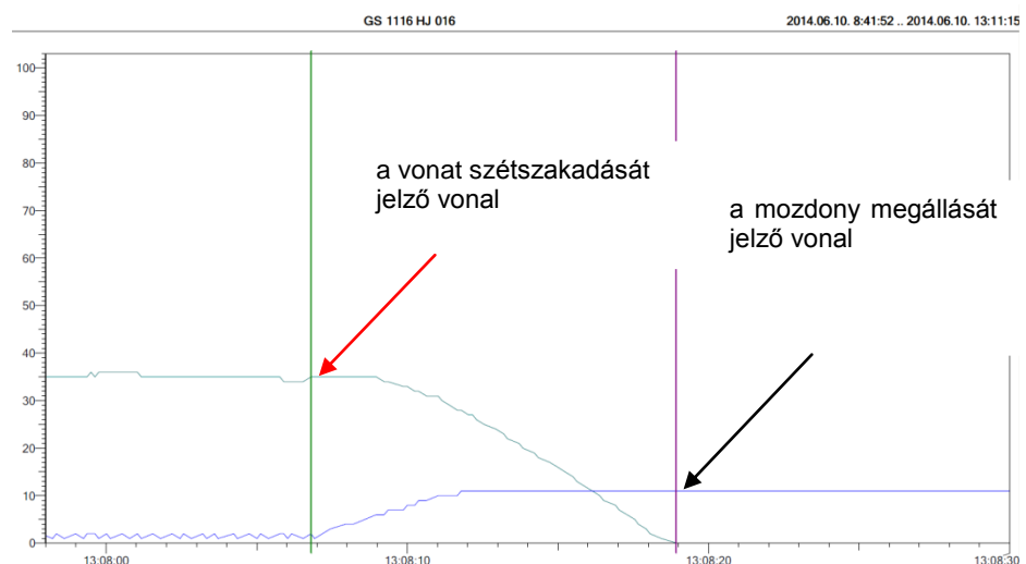
13. ábra: a 116 016 mozdony menetíró regisztrátuma
