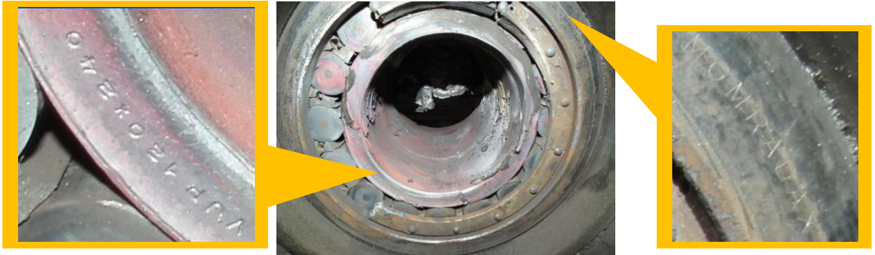
6. ábra: a balesetet okozó sérült csapágyazás (csapágy típusa, gyártó jele)
