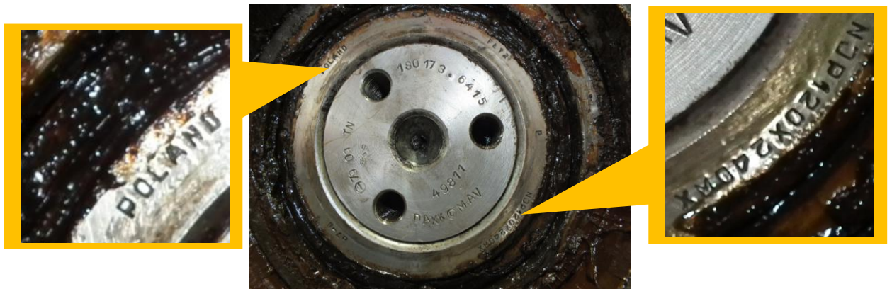
7. ábra: a sérült csapágyazással ellentétes oldali csapágyazás (gyártó jele, csapágy típusa)
