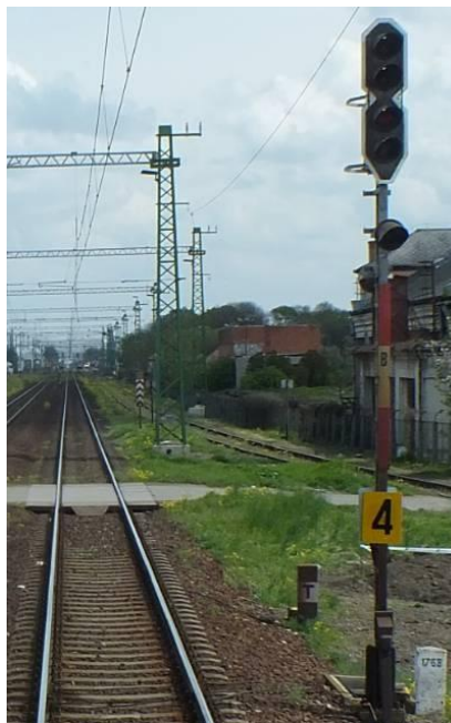
6. ábra: A „B” jelű bejáratú jelző, melyen a pótvörös fény világít
