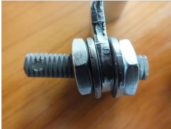
13. ábra: Törött, deformálódott zár
