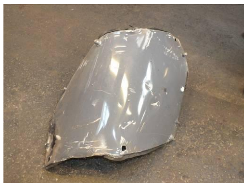
11. ábra: A deformálódott burkolat
