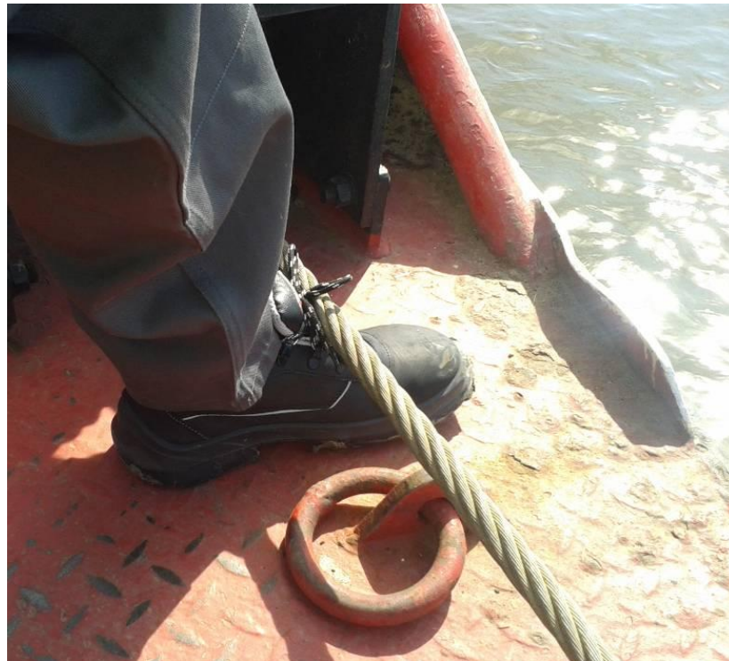
4. ábra: a csatolókötel botlásveszélyes elhelyezkedése
