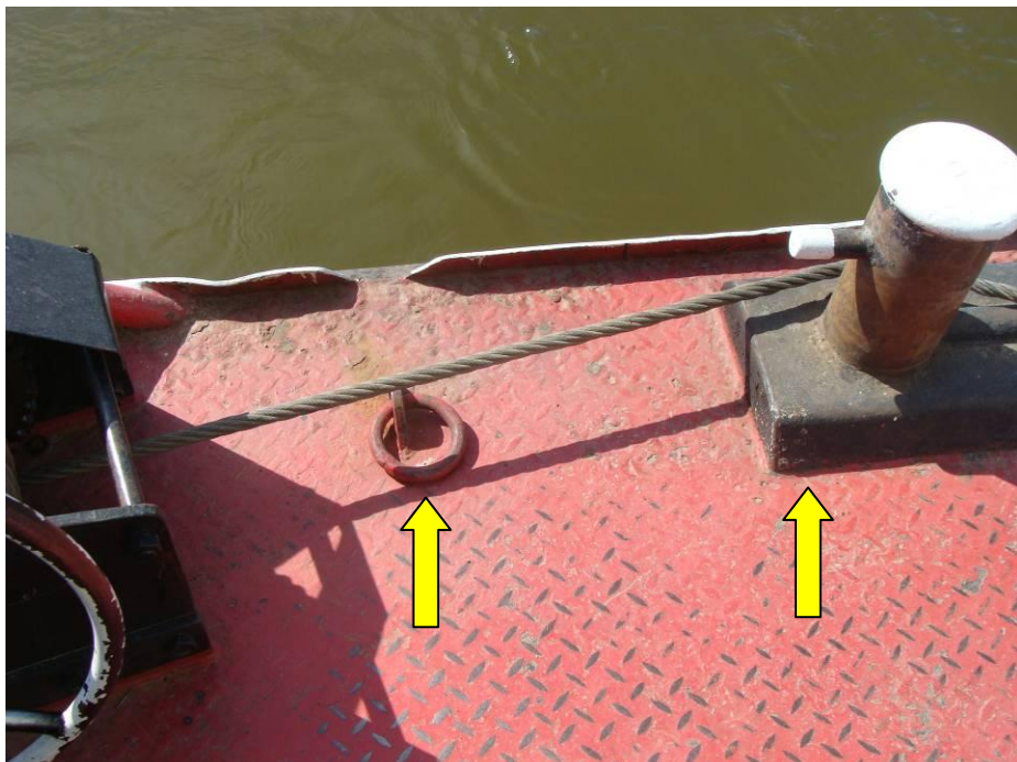
5. ábra: további botlásveszélyes szerkezeti elemek a hátsó fedélzeten
