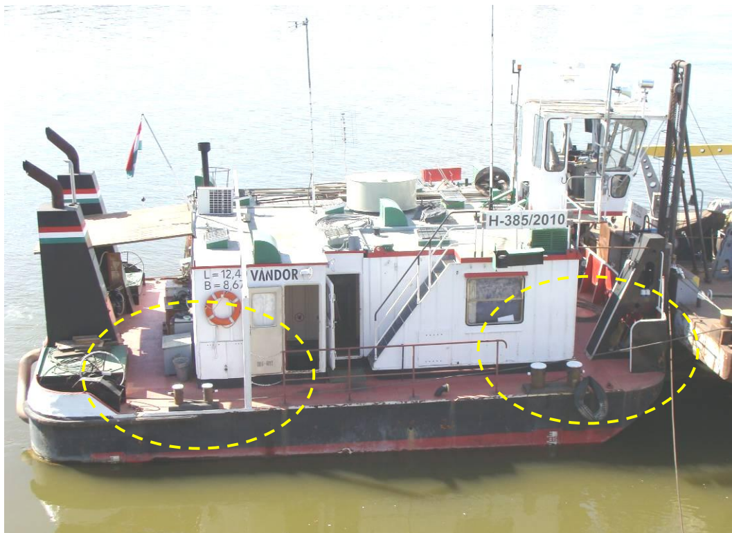
6. ábra: védőkorlát hiánya a kötélbakok környezetében
