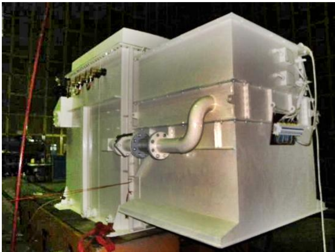
5. ábra: A transzformátorral egybeépített olajhűtő-egység (Kép: Softronic)
