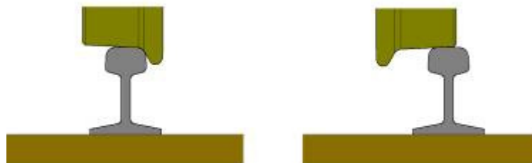
7. ábra: Haladás közbeni kapcsolat nyombővült pályán
