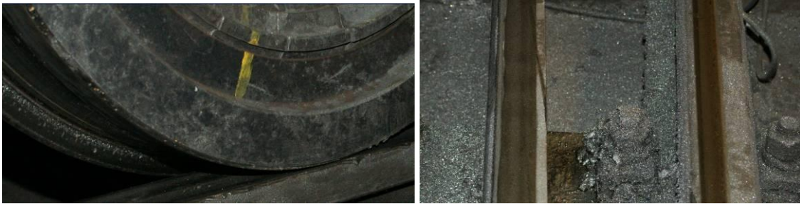
6. ábra: Súrlódási nyomok a nyomkarimán és a sínszálon
