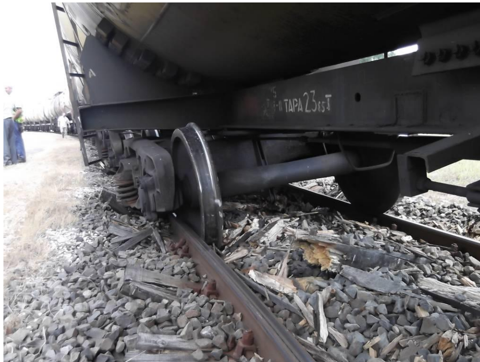
5. ábra: az elhasználódott faaljak a siklás helyén
