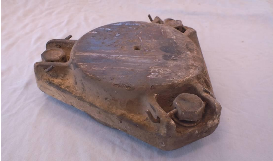
5. ábra: kopásnyom a rugófedélen
