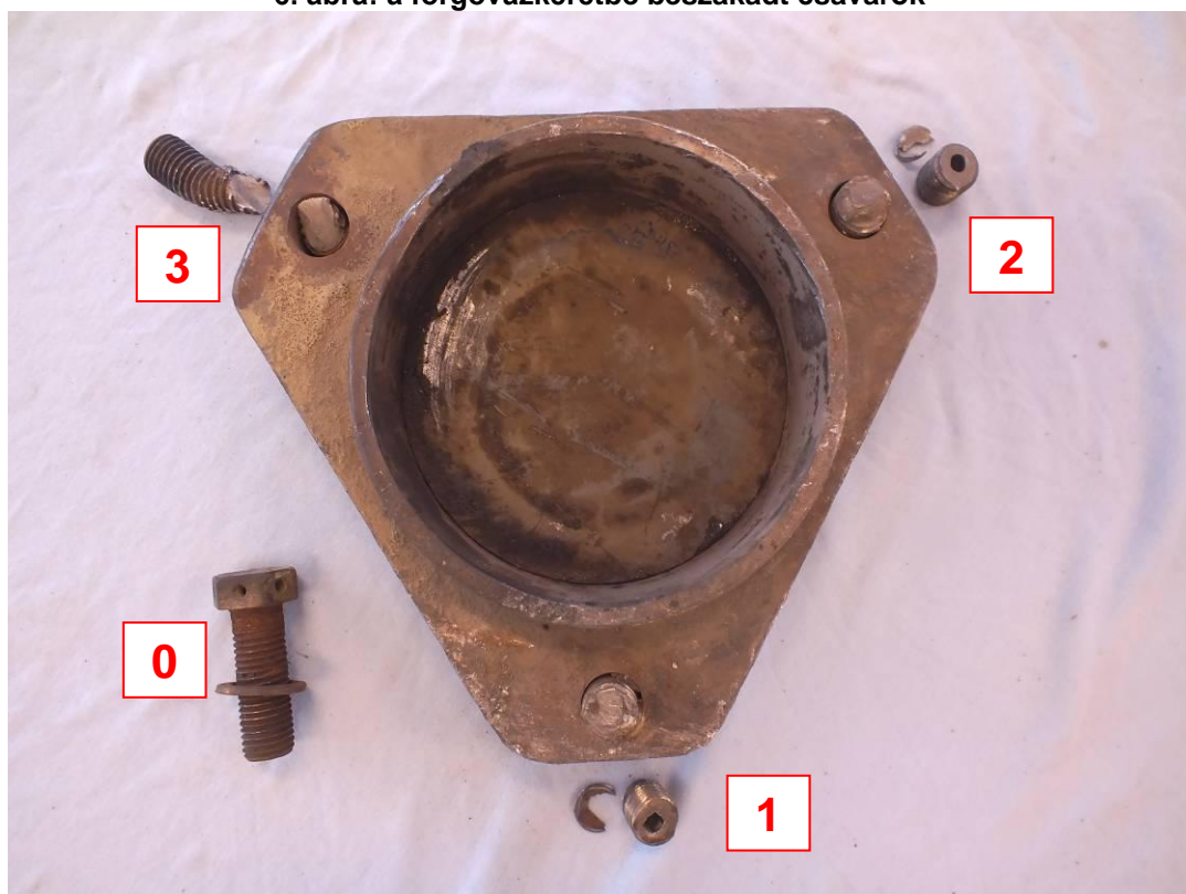
7. ábra: a fedélben maradt csavartöredékek, a forgóvázkeretből kiszedett csavardarabok (a kihajtáshoz szükséges furatokkal) és egy ép csavar
