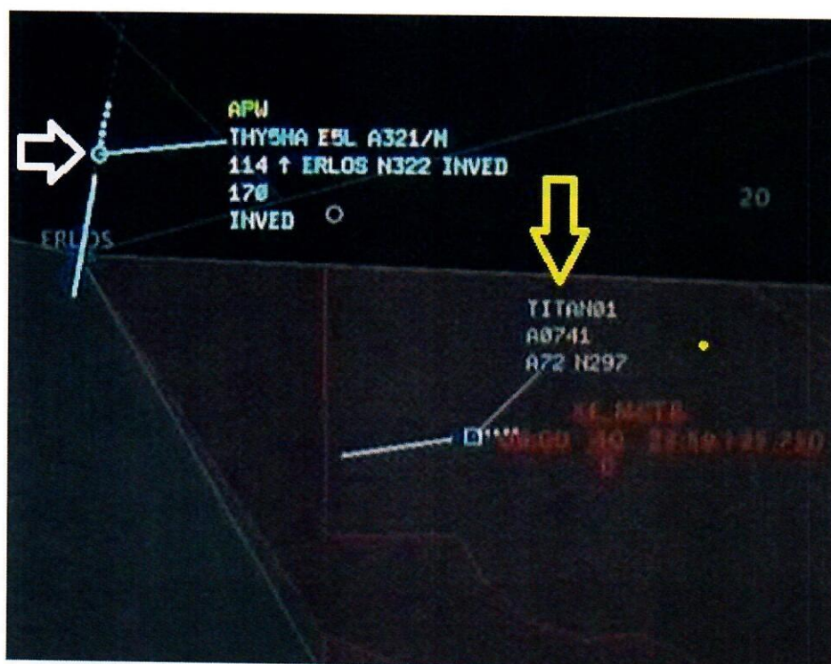
3. ábra Az APP szektor radarképe UTC 10:12:15-kor, amikor LHKE ATC a TITAN01 kötelék rádió frekvencia váltását kezdeményezte. A TITAN01 kötelék radar címkéje 7.200 láb magasság kijelzéssel látható. (fehér nyíl THY5HA, sárga nyíl: TITAN01)
