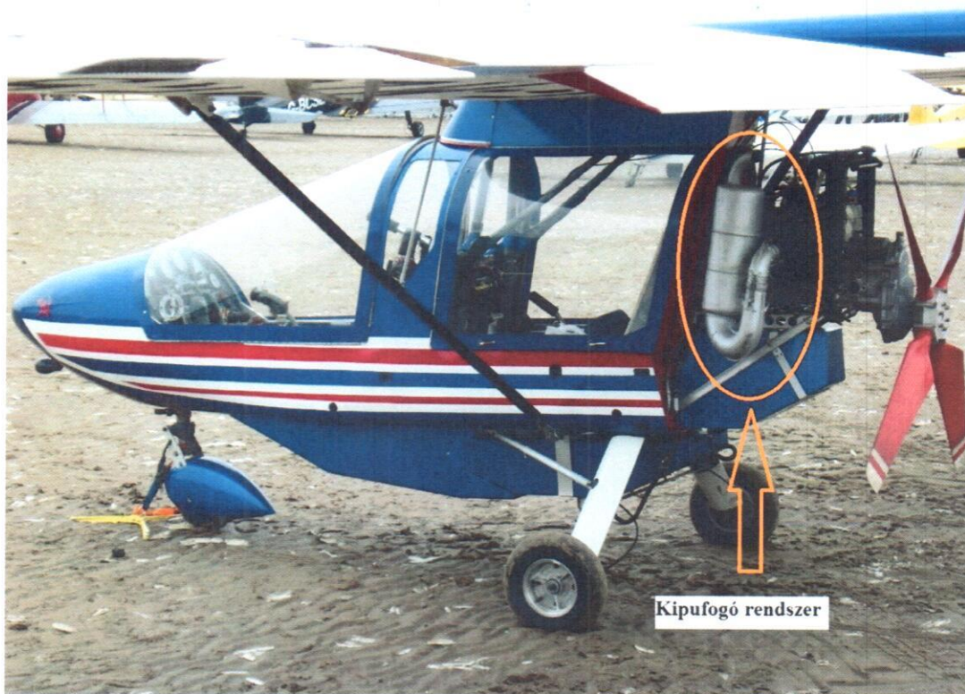
7. ábra: Kipufogó rendszer gyári kialakítása és elhelyezkedése
