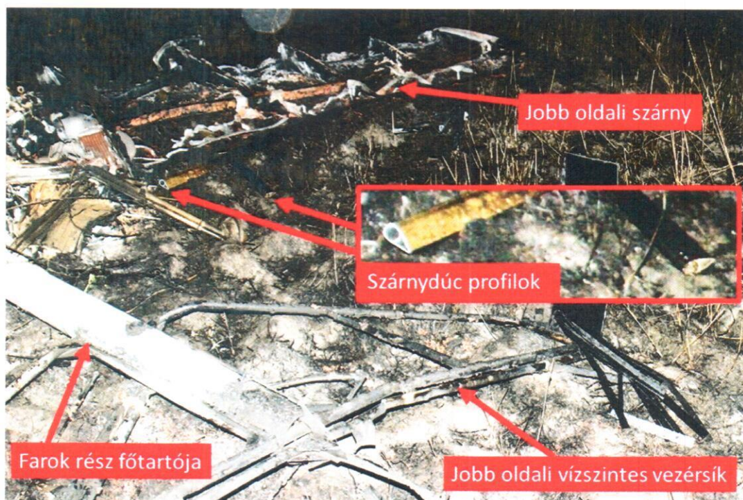
4. ábra: A roncsron fellelt áramvonalas kialakítású szárnydúc profilok
