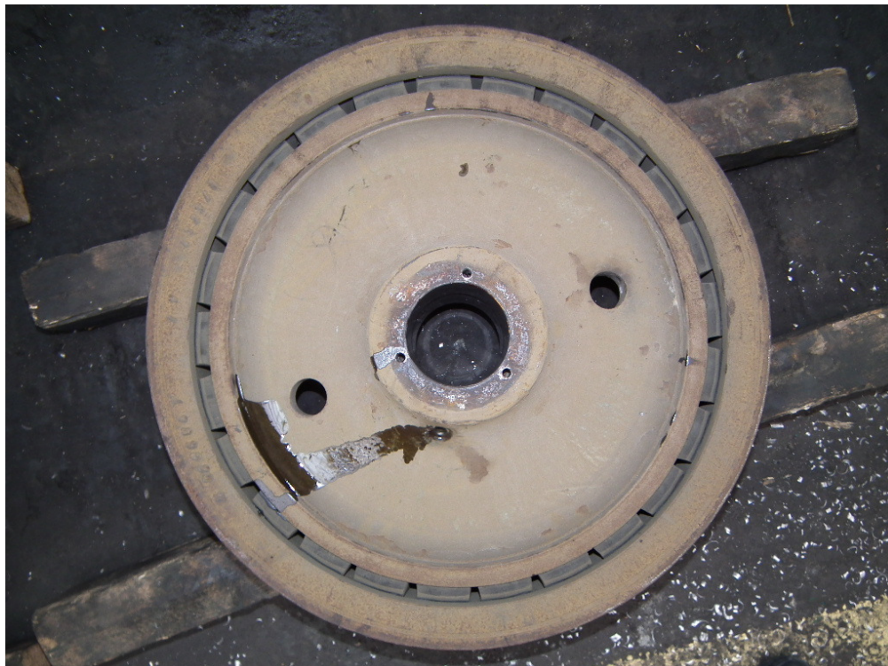
5. ábra: jól láthatóak a gumirugók a kerékben
