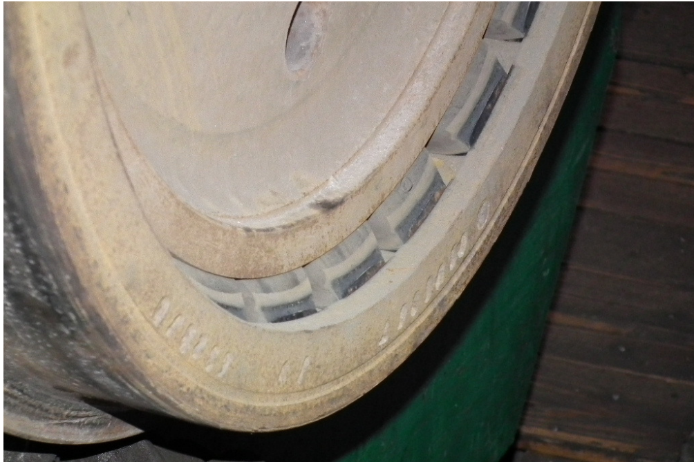
6. ábra: a gumirugók a sajtólasos próba végkitérésénél
