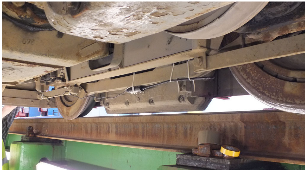
9. ábra: kamera elhelyezése a forgóvázon
