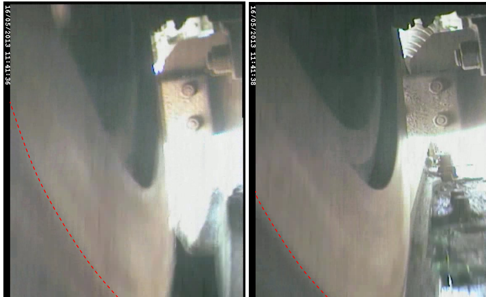
11. ábra: a kerék állapota megközelítőleg a kisiklás helyén és utána a kitérő egyenes irányában
