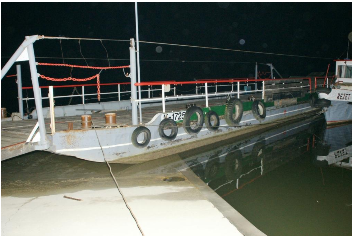
3. sz. ábra: A 38 tonna teherbírású K-1725 jelzésű komp kitolva a partra, látható, hogy a komptest eleje felül a beton rézsús, lejtős részre
