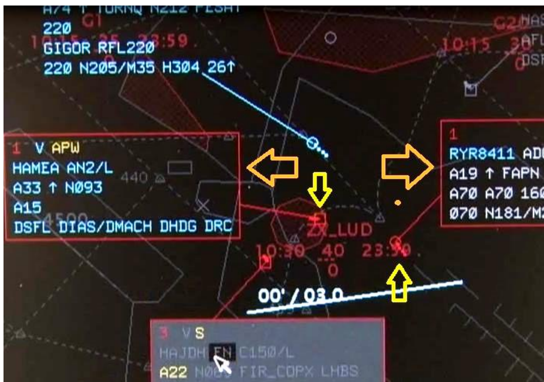
1. sz. ábra, APP radar képernyő UTC 10:37:10 órakor, amikor a HA-MEA repülőgép és a RYR8411 járat (kis sárga nyilak) között STCA riasztás jelent meg (nagy barna nyilak)
