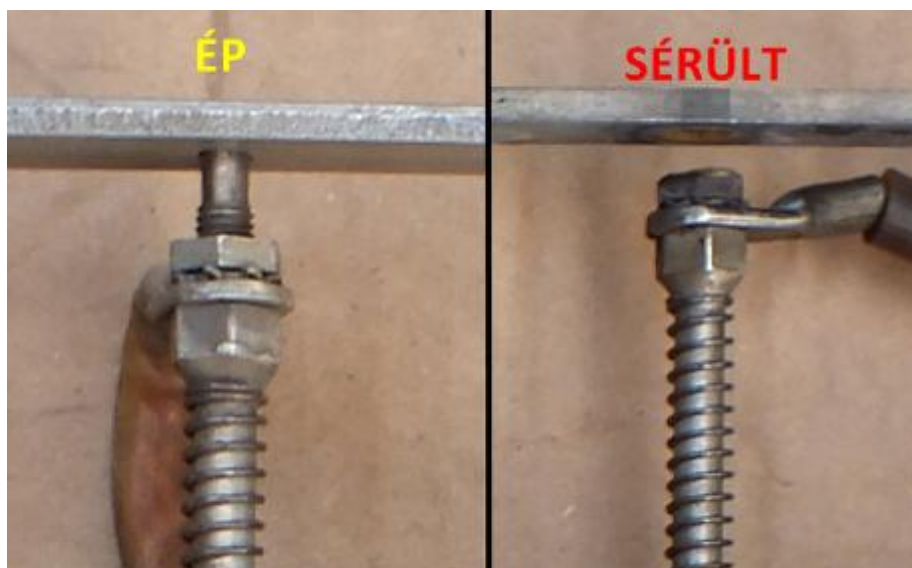
9. ábra: A kiégett kocsiából származó sérült és egy ép biztonsági hőkioldó
