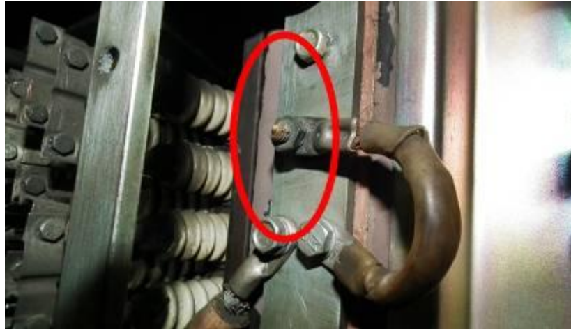
5. ábra: A sérült hőkioldó az 51 55 20-80 003-5 pályaszámú kocsiban
