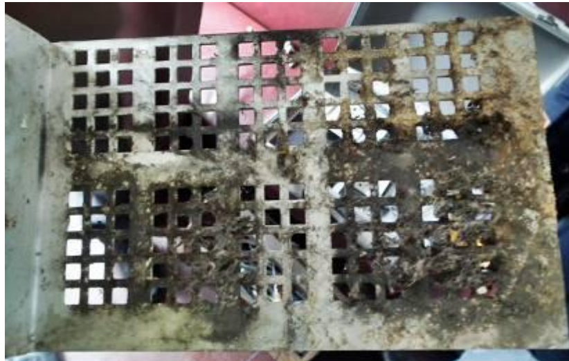
10. ábra: A műszaki szemle során kiszertelt, szennyezett befűvórács
