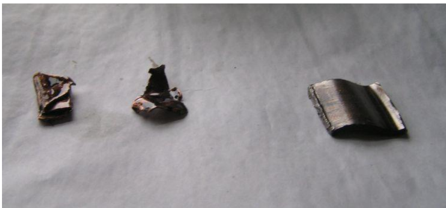
6. számú ábra – a HA-SKS repülőgép motorjának hengeréből előkerült törött hajtórúdszem darabok
