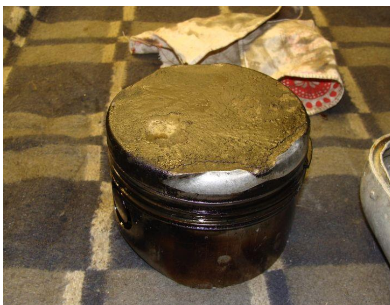
4. számú ábra – a HA-SKS repülőgép motorjának kiszertelt dugattyúja
