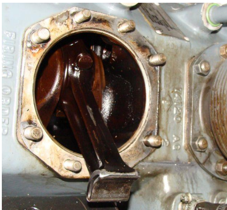
3. számú ábra – a HA-SKS repülőgép motorjának hajtórúd szára a sérült hajtórúdszemmel
