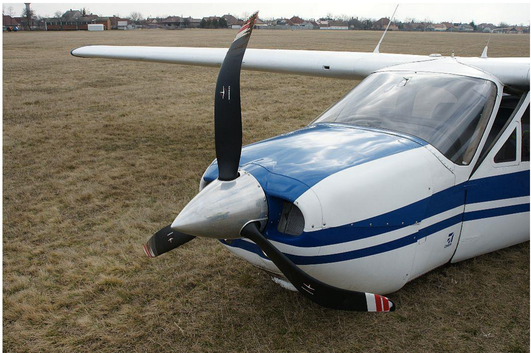
3. számú ábra – a HA-JDU lajstromjelű repülőgép sérült légcsonkja.
