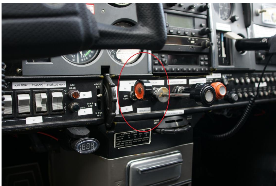
5. számú ábra – a HA-JDU lajstromjelű repülőgép műszerfala a behúzott helyzetű futómű vezérlő karral.
