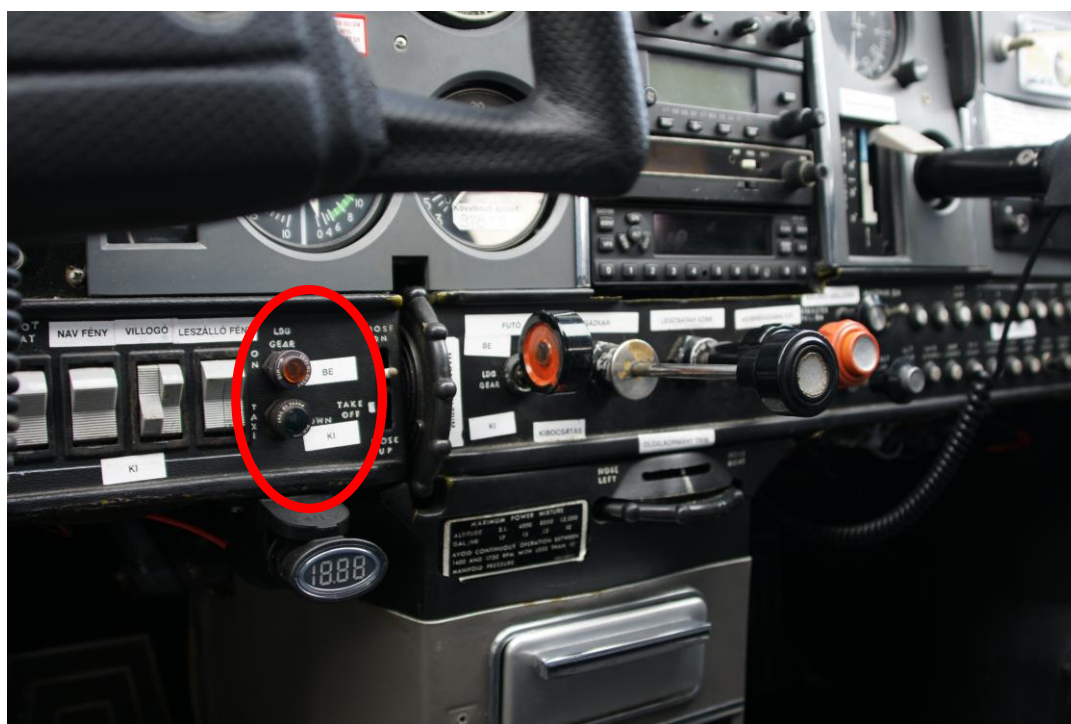
1. számú ábra – a HA-JDU lajstromjelű repülőgép műszerfalán a futó kinti helyzetét jelző zöld, valamint a benti helyzetet jelző borostyán színű lámpa
