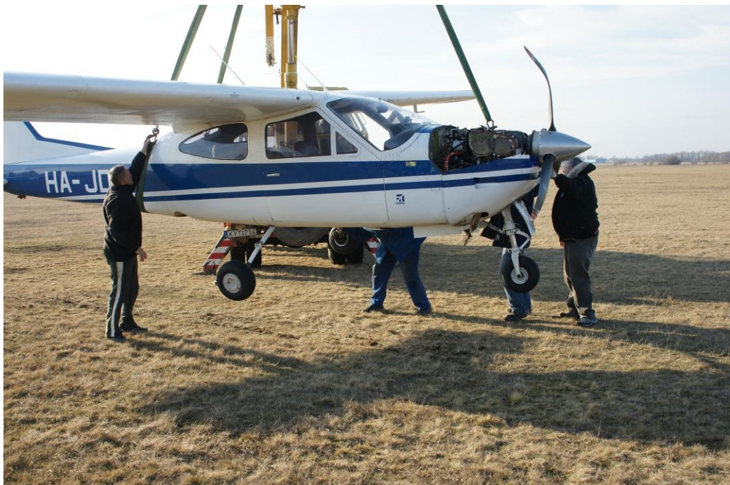
4. számú ábra – a felemelt HA-JDU lajstromjelű repülőgép futómű nyitása az esemény helyszínén
