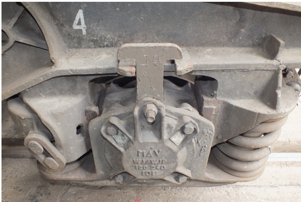
5. ábra: a bal ágyvezeték fényes, a jobb rozsdás
