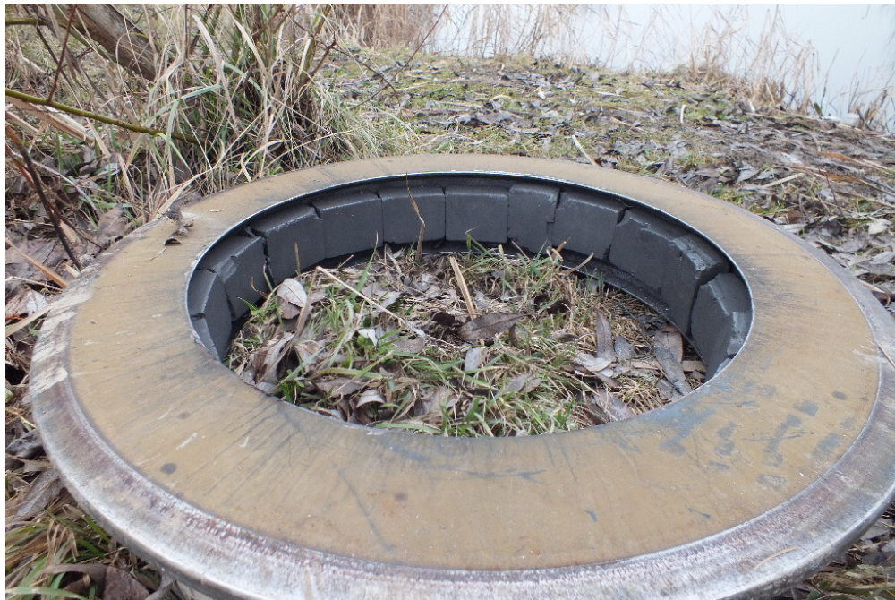
7. ábra: az abroncs a gumirugókkal, a helyszíneléskor
