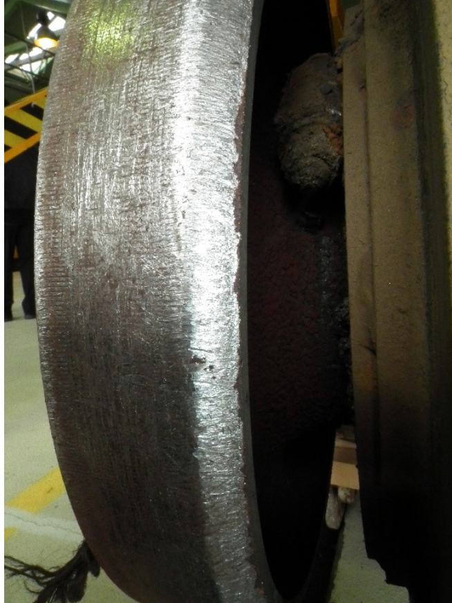
14. ábra: a kerékváz lekopott éle
