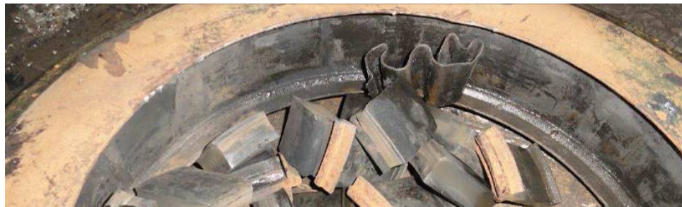
23. ábra: „D” kerék (Közvágóhídon lazult) (fotó: BKV Zrt.)
