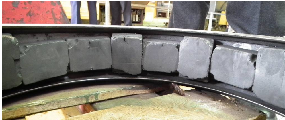
9. ábra: gumielemelek a kerékabroncsban
