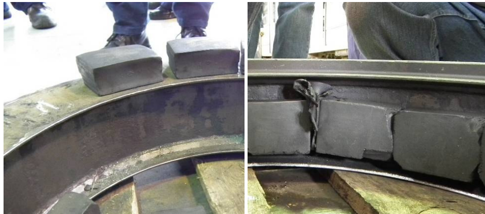
20. ábra: „A” kerék (a balesetben szétesett)
