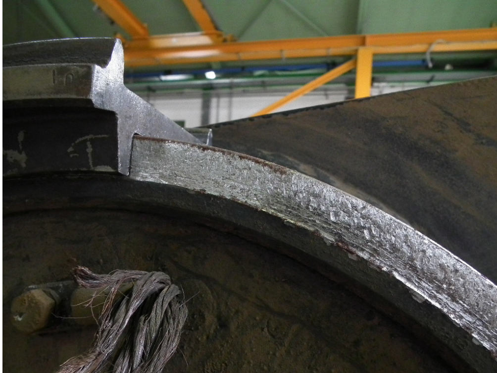
15. ábra: kopásnyom a kerékváz oldalán
