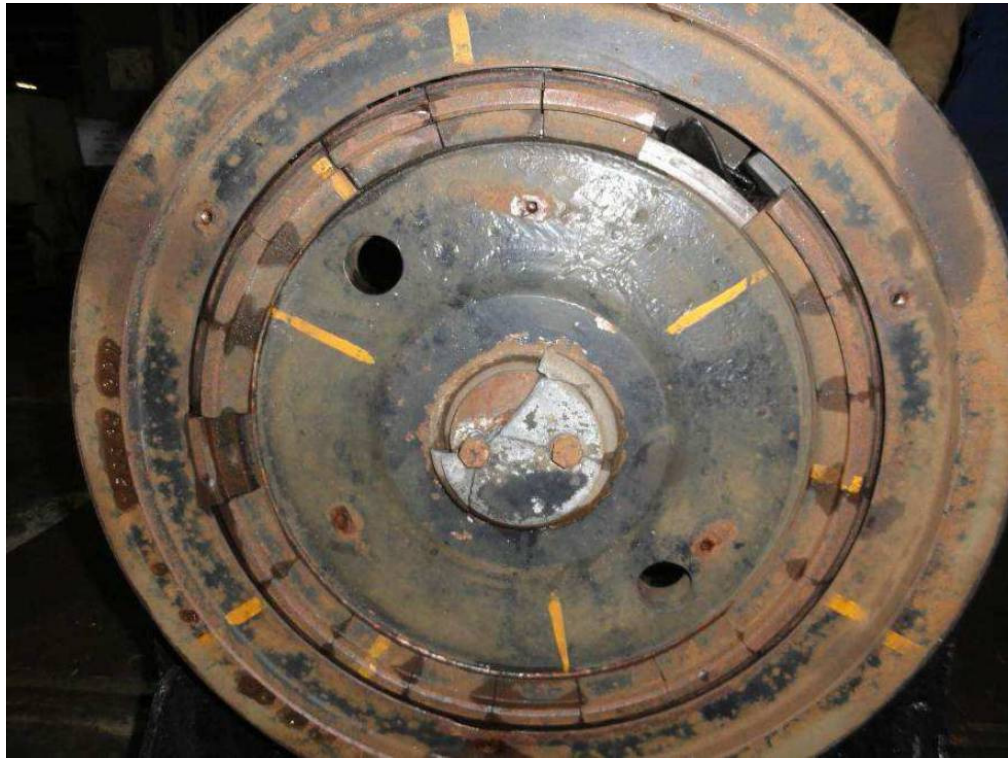
16. ábra: a Közvágóhídnál észlelt kerékhiba (fotó: BKV Zrt.)
