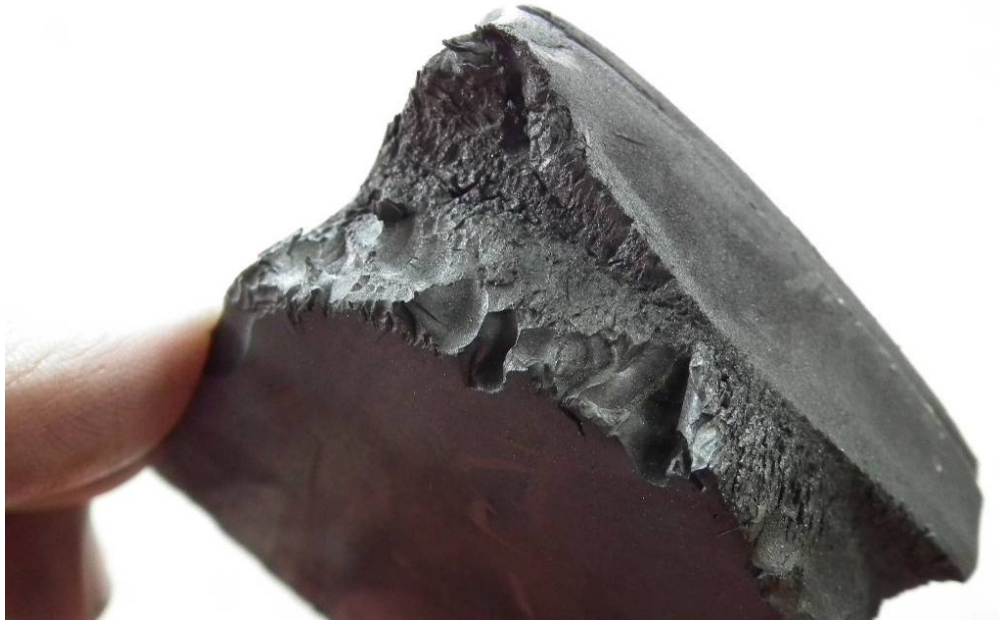
11. ábra: roncsolódott gumirugó
