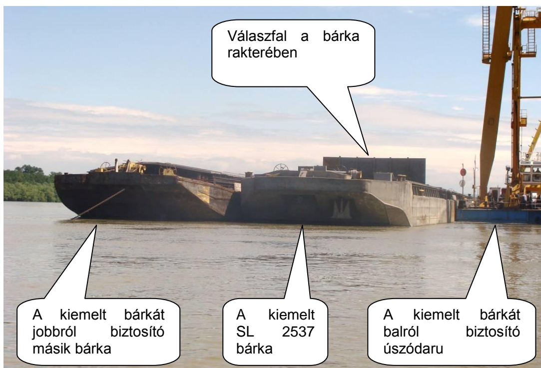
3. sz. ábra: A kiemelt bárka Kétoldalról egy másik bárka illetve egy úszódaru biztosítja
