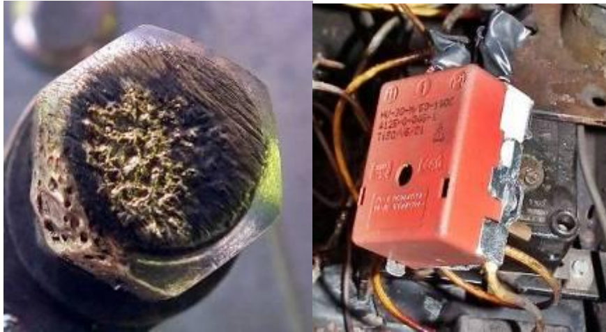
11. ábra: A hőkioldó tengelyvégén talált elektromos zárlatra utaló nyom (balra) és a rögzítetlen termosztát (jobbra)
