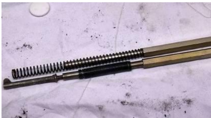
9. ábra: A 2/3-os részből kiserelt tengely és rugó a megolvadt olvadóbetéttel (alul)
