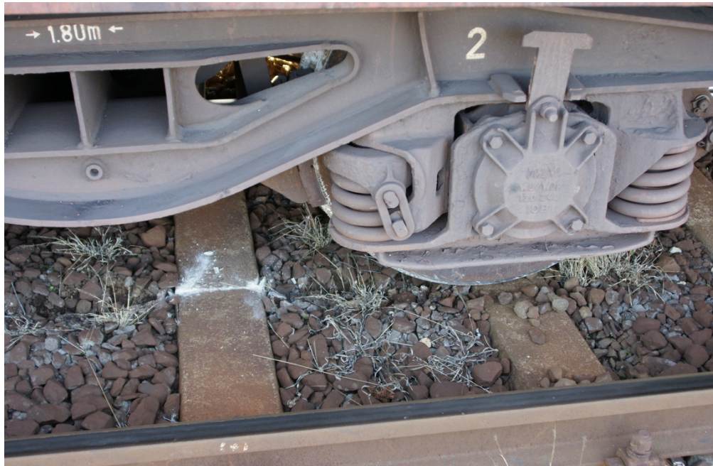
13. ábra: közéesés nyoma a keréken
