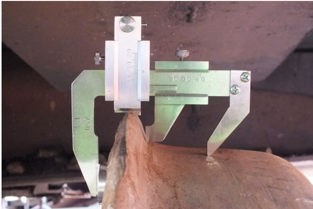
6. ábra: kerékadatok mérése a helyszínen
