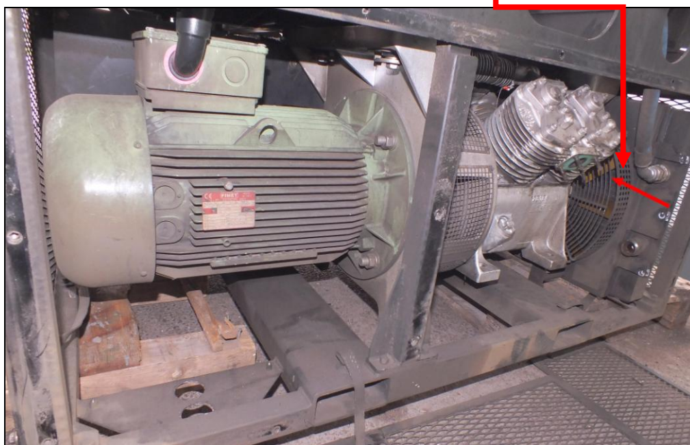
7. ábra A kompresszor egység kiszerelt állapotban (a kép a lapátkerék színét, méretét, elhelyezkedését szemlélteti a balesetben érintett egység hátsó nézetéből)
