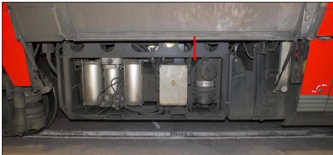
5. ábra Az 1-es kompresszor egység, és a hiányzó lapátkerék helye (piros nyíl) (nem a balesetben érintett jármű képe)
