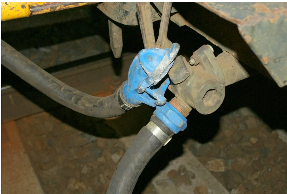
9. ábra: A lógó fővezeték tömlőn ütésnyomok
