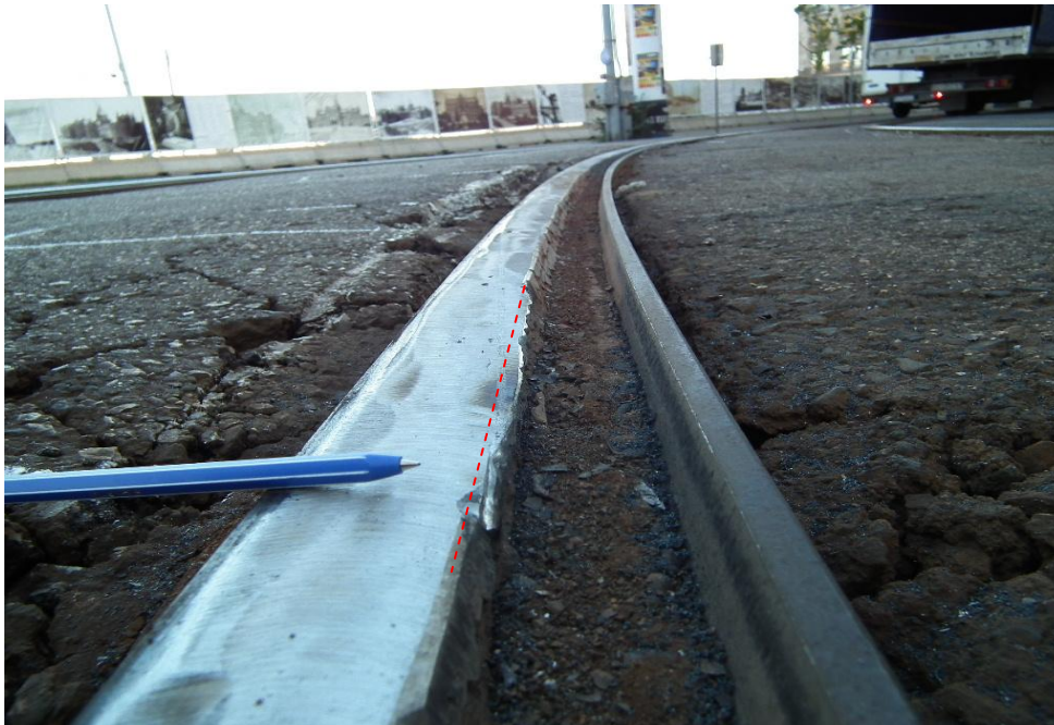
6. ábra: kidomborodás a sínen és felkapás helye a toll hegyénél, a második kisiklás után
