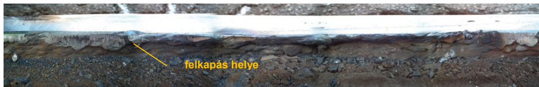
ábra: a kisiklást okozó domborulaton nincsenek oldalsó kopásnyomok
